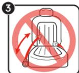
Cinturón de seguridad para la falda sin traba con retractor de traba de emergencia (Emergency Locking Retractor, ELR)
