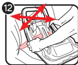
12 Pruebe la tensión. Agarre los costados del base donde se encuentra la correa del LATCH y deslice el asiento de un lado a otro y de atrás hacia delante. Si el base se mueve menos de 1 pulgada (2.5 cm), está suficientemente tensionado.
