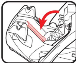
2 Abra la puerta de almacenamiento del LATCH e inserte los conectores del LATCH en las ranuras de almacenamiento. Ponga las correas del LATCH en el compartimento de almacenamiento y cierre la puerta de almacenamiento.
