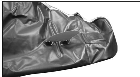
10. Déplier le kayak et fixer l'aileron amovible sur les connecteurs se trouvant sous la partie arrière du kayak, en accrochant les onglets de l'aileron dans les rainures des connecteurs.
