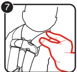
7 Si puede hacer un pliegue en la correa, no está tensa y debe ser tensionada más.
