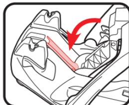
2 Abra la puerta de almacenamiento del LATCH e inserte los conectores del LATCH en las ranuras de almacenamiento. Ponga las correas del LATCH en el compartimiento de almacenamiento y cierre la puerta de almacenamiento.
