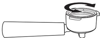
**REMARQUE :** Pour retirer et nettoyer le filtre, tournez le filtre vers la gauche ou la droite pour aligner l'encoche du filtre avec la rainure à l'intérieur du porte-filtre.
