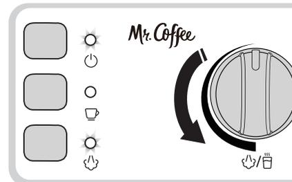
Lorsque le voyant de vapeur devient solide, tournez le cadran d'intensité de la vapeur vers la gauche afin de régler l'intensité de la vapeur.
