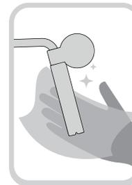
Essuyez la buse et la buse vapeur avec un chiffon humide. Retirez le couvercle de la lance à vapeur pour nettoyer complètement la lance à vapeur.
