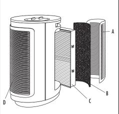
A. AIR INLET GRILL B. WASHABLE FOAM PRF-FIITFR HEPA-TYPE/CARBON FILTER ). FILTERED AIR OUTLET IONIZER LIGHT IONIZER CONTROI G. SPEED CONTROL
