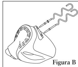
**NOTA:** El gancho para masa con el collarín encaja en el orificio izquierdo y el otro en el derecho. (Ver Figura B) Si los ganchos para masa no encajan en los orificios, invierta la posición e intente nuevamente.
