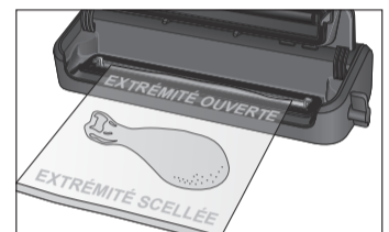
Placer le sac dans la fente d'aspiration
