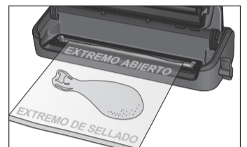
Coloque la bolsa en el canal de vacío
